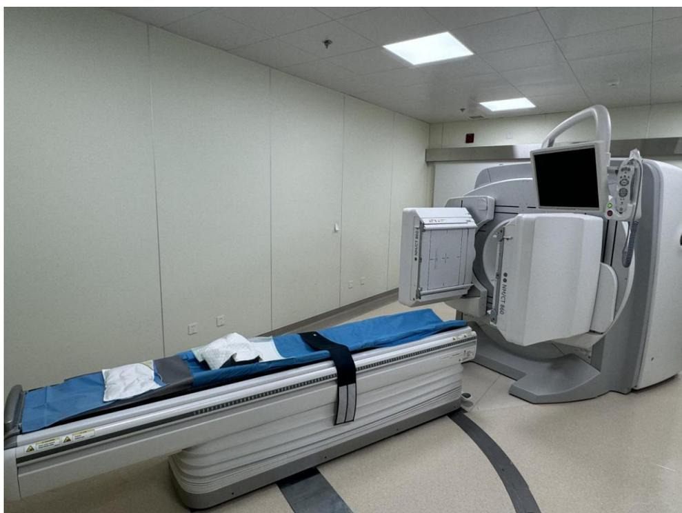
图 2-3 同类型 SPECT/CT 机设备外观图
