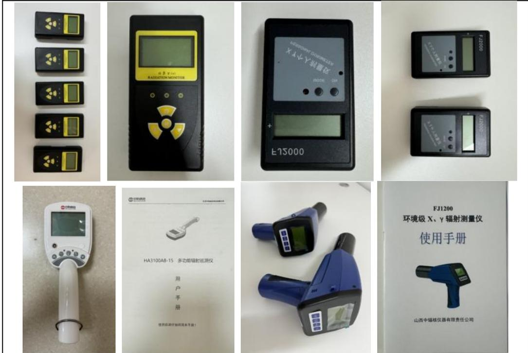
个人剂量报警仪、1 台表面污染监测仪、1 台电离辐射巡测仪
